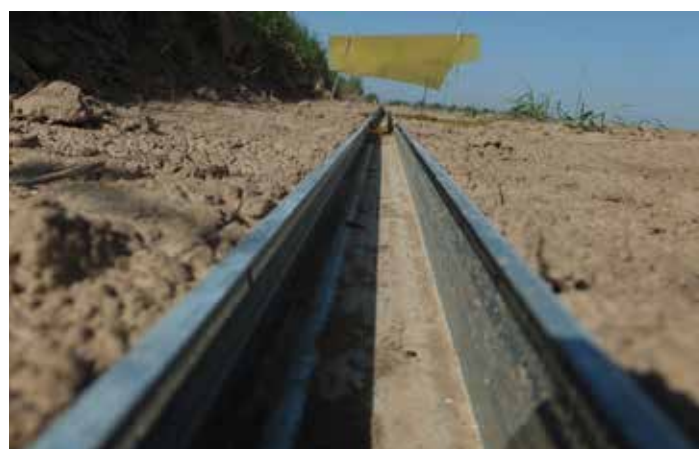
Fot. 2. Rynienka wykonana z stelażu do płyt KG
